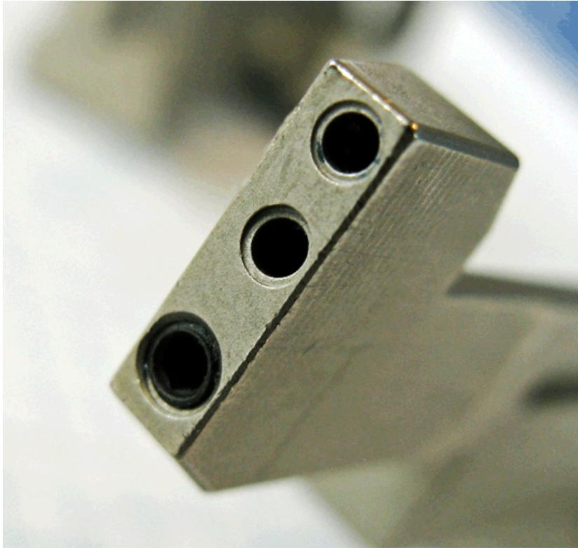
Die aus den beiden vorderen Bohrungen des Spannkeils austretenden Hochdruckstrahlen kreuzen sich dank einer leicht angewinkelten Anordnung exakt an der Position der Werkzeugschneide. Foto: Klaus Vollrath
