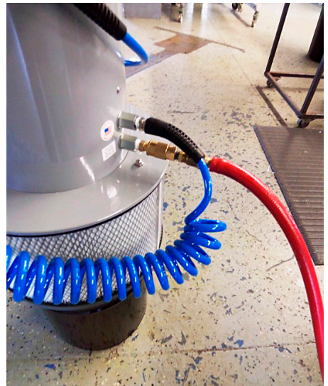
Le tuyau droit fournit de l'air comprimé au typhon ® .
