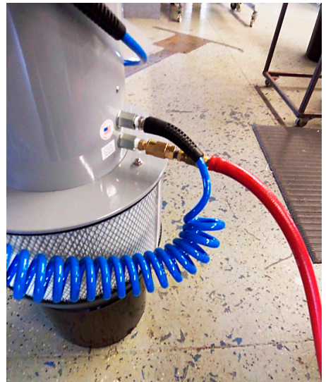
Gerader Schlauch versorgt das typhon® Gerät mit Druckluft.
