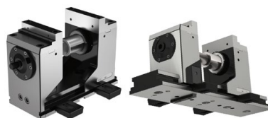
Ausrichtung durch Präzisions-Nutensteine 20 H7 im Grundkörper (H5G) und Ausrichtsätzen 14 / 16 / 18 in der T-Nut des Maschinentisches. Aufspannung mit Spannpratzen.
